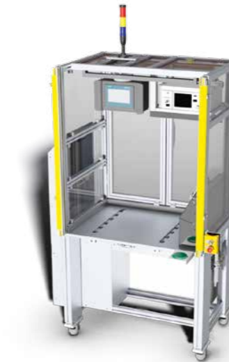
MP EcoLine 1000: ausgestattet mit Dichtigkeitsprüfsystem und überwachtem Ausschussschacht
