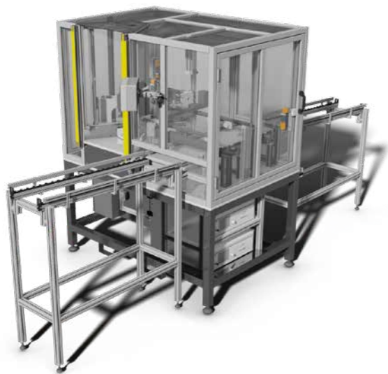
Halbautomatische Rundtaktanlage mit manueller Bestückung und einem sicheren Einlegebereich für die Montage und Prüfung von Baugruppen. Montierte und kontrollierte Bauteile werden automatisiert in Trays verpackt. Eine Zu- und Abführung dient als Pufferfunktion.
