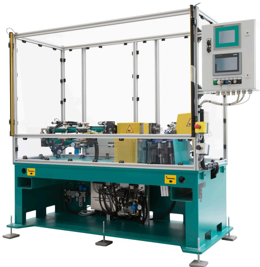
Einpressmaschine für Turboladegerhäuse
