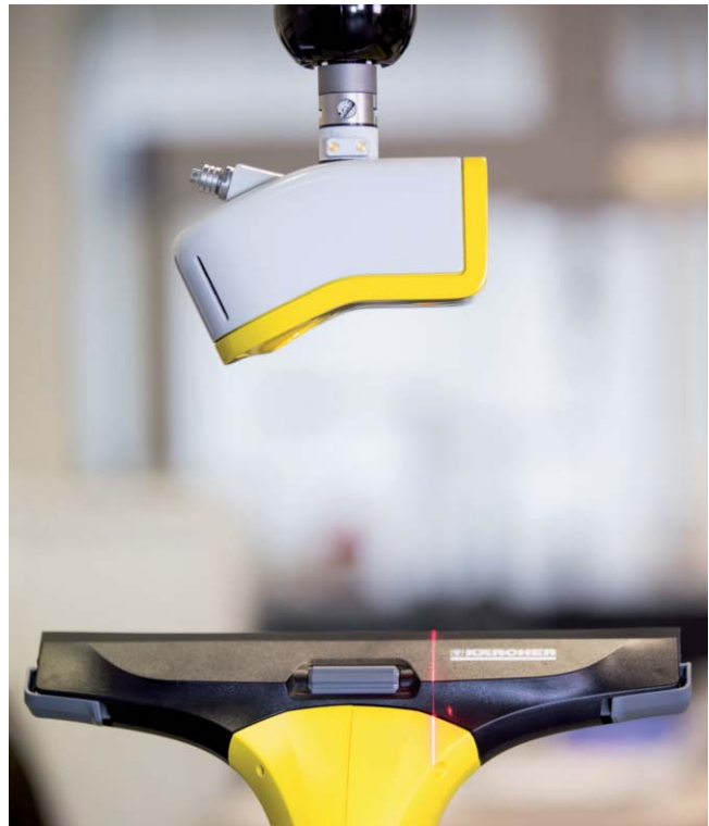
Der Laserscanner lässt sich auf unterschiedlichen Koordinatenmessgeräten einsetzen und erfasst schnell komplexe 3D-Konturen auf stabilen und nachgiebigen Bauteilen mit matten und glänzenden Oberflächen ohne individuelles Kalibrieren.
