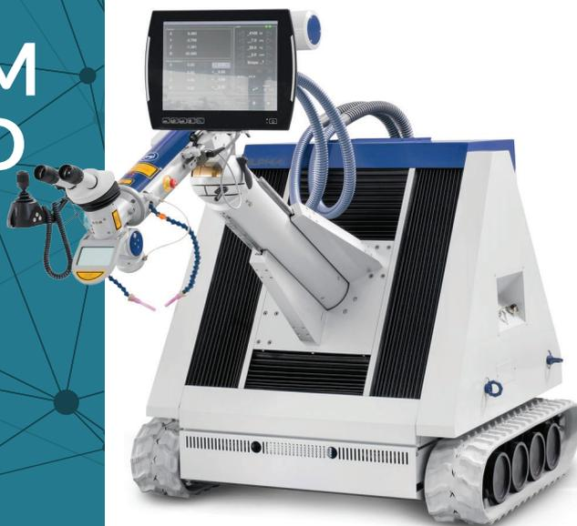
Oftmals sind es kleine Beschädigungen, die die Produktion ganzer Fertigungen lahmlegt. Hier bietet sich das Laserschweißen an, es kann schnell, zuverlässig und lokal an den beschädigten Bereich angewendet werden, ohne das umliegende Gefüge in Mitleidenschaft zu ziehen wie beim herkömmlichen Schweißen. Das Zusatzmaterial kann so gewählt werden, dass die gewünschte Härte ohne eine nachträgliche Wärmebehandlung aufgebracht werden kann.
