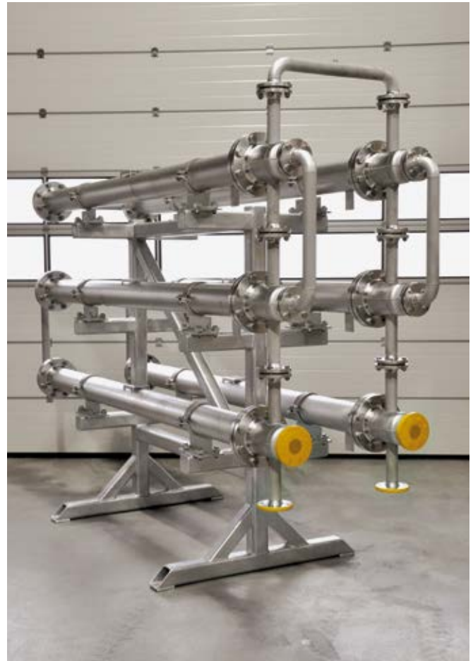
Verweilzeitreaktor mit Verweilzeit > 2 Stunden
