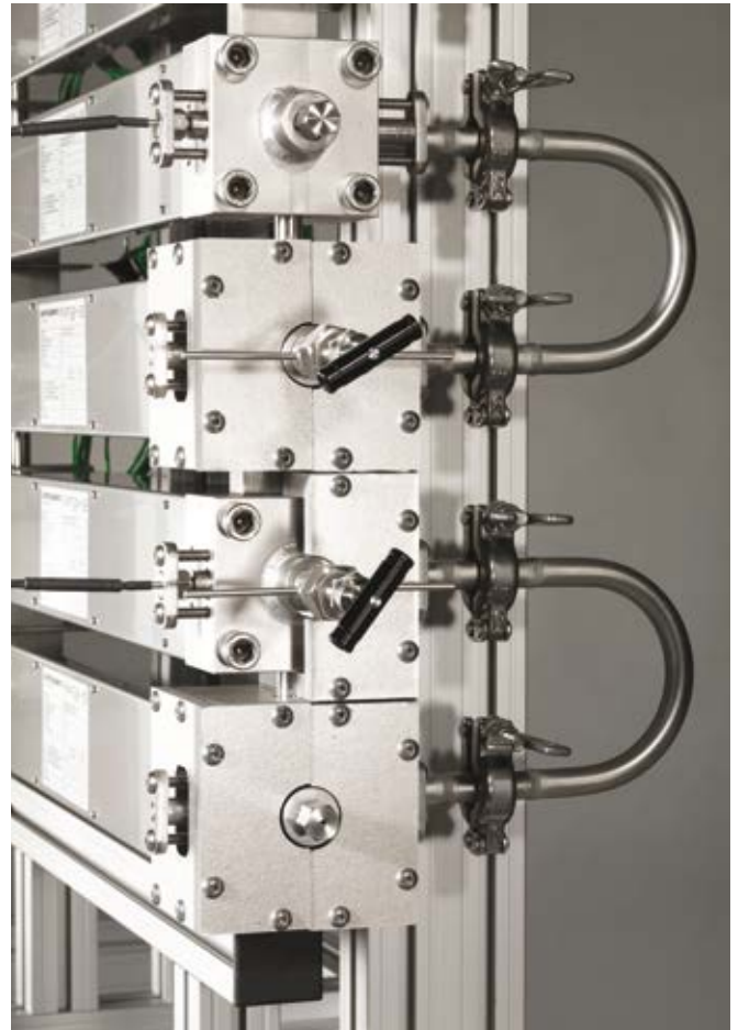
ContiplantPILOT Reaktoren mit standardisierten Ventilen und Sensoren
