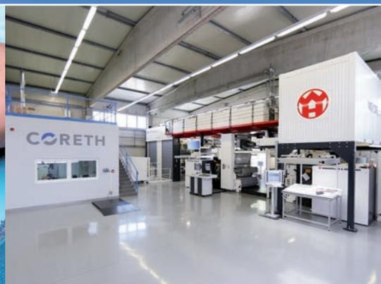
2013 erfolgte die Inbetriebnahme der 8 Farben Hochleistungs-Zentralzylinder-Flexodruckmaschine in unserem neuen Druckzentrum mit einer maximalen Druckbreite von 1.300 mm.
