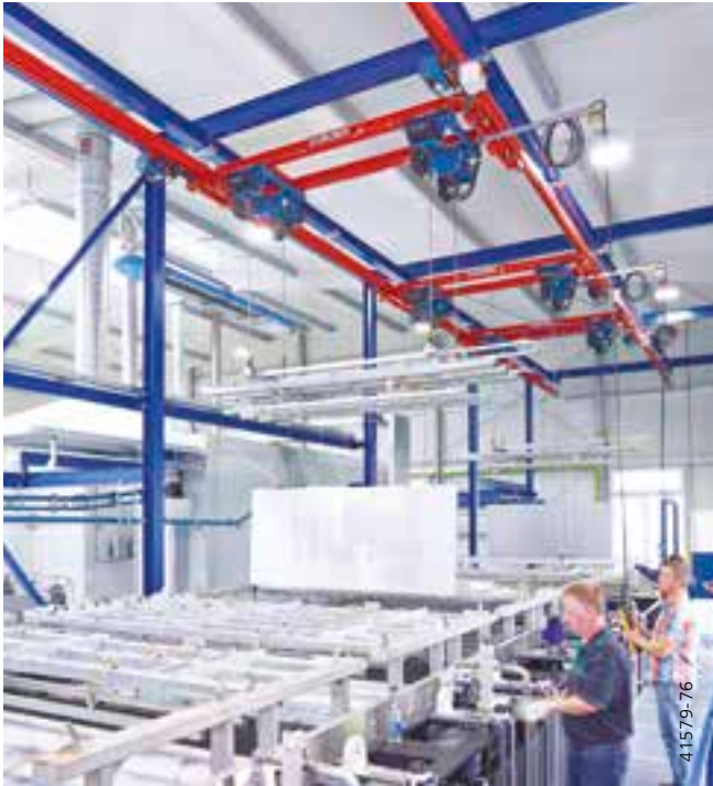
Doppelkettenzüge im Tandemeinsatz mit vier Kettenabläufen
