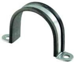
**SHG und USHG Rohrschellen** können zur Befestigung von statisch verlegten Wellrohren verwendet werden. Sie sind aus verzinktem Stahlband gefertigt (nach DIN 3016). Die Einfassung des Stahlbandes mit halogenfreiem Elastomerprofil ermöglicht eine optimale Anpassung an die montierten Wellrohre.
