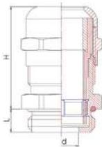
Die Kabelverschraubung EMV easyCONNECT gewährleistet die volle Installationskontrolle und gleicht Toleranzen in den Schirmdicken für einen sicheren Schirmabgriff aus. Das Federsystem ermöglicht eine gute und sichere Schirmkontaktierung sowohl bei partiell abisolierten Abschirmkabeln als auch bei vollständig freigelegten Kabelschirmen.
