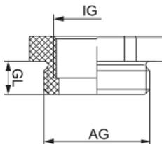
**Aussengewinde ( AG ) metrisch, Innengewinde ( IG ) PG / male thread ( AG ) metric, female thread ( IG ) PG**
