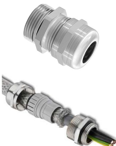
Standard Kabelverschraubungen aus Messing mit einem Klemmkäfig. Schirmkontaktierung erfolgt bei einem in der Kabelverschraubung endenden Schirmgeflecht
