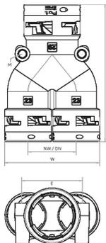
**Wellrohrverteiler-Anschlussarmatur Typ Y** zur Aufteilung eingehender Leitungen. Durch die parallel verlaufenden Ausgänge in Richtung der Eingehenden Leitung, können Kabel und Litzen problemlos eingeführt und durch die Armatur gezogen werden. Geeignet für normale Anforderungen in technischen oder Elektroinstallations-Anwendungen, insbesondere für erhöhte Anforderungen in Industrie und Bahntechnik bei gleichzeitiger Abdichtung über das Wellrohr von bis zu IP69K.
