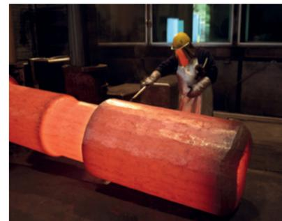
Ein verbessertes Materialgefüge erlaubt in Kombination mit einer entsprechenden Wärmebehandlung besonders gute mechanische Eigenschaften, wie z. B. Zugfestigkeit, Härte und Zähigkeit der Werkstücke. Unter Druck, unter starken Temperatureinflüssen, aber auch unter hohen Zuganforderungen zeigen unsere Schmiedestücke ihre wahren, inneren Werte. Somit ermöglichen wir Ihnen individuelle Abmessungen und werkstofftechnische Eigenschaften – speziell angepasst an Ihre Pläne.
