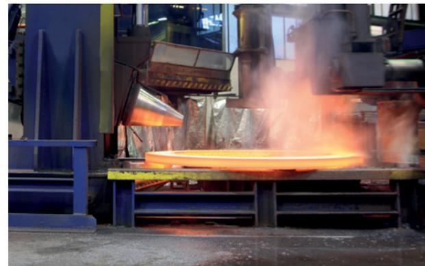
Auf unseren beiden computergesteuerten Ringwalzwerken fertigen wir aus vorgeschmiedeten Rohlingen nahtlose Ringe
