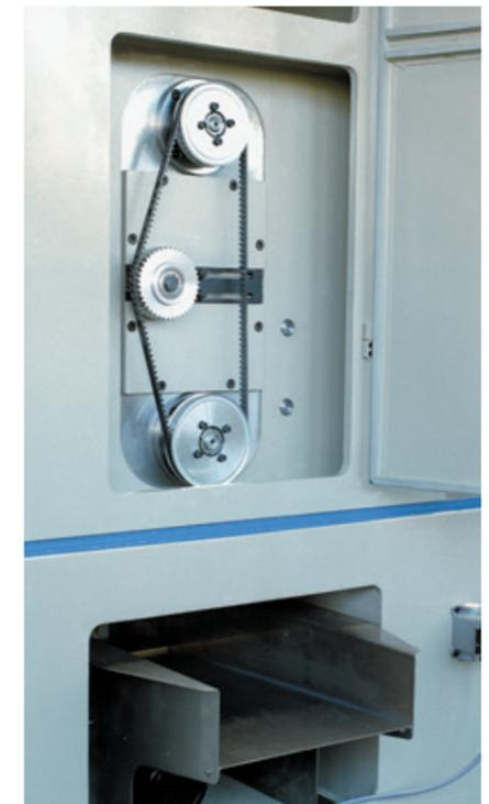
Nockentrieb mit austauschbaren Kettenrädern
