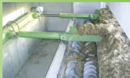
Doppelförderschnecke verhindert Brückenbildung
