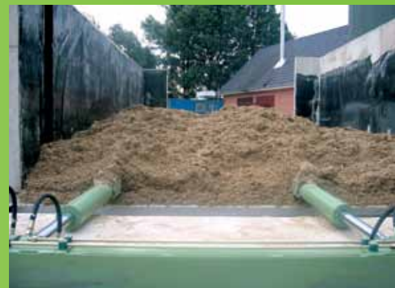
Doppelförderschnecke verhindert Brückenbildung
