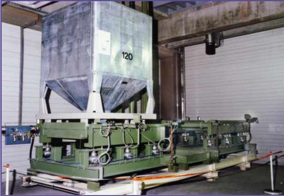
Vibrationstische mit aufgebautem Rollengang für eine Umfüllanlage in der kunststoffverarbeitenden Industrie.
