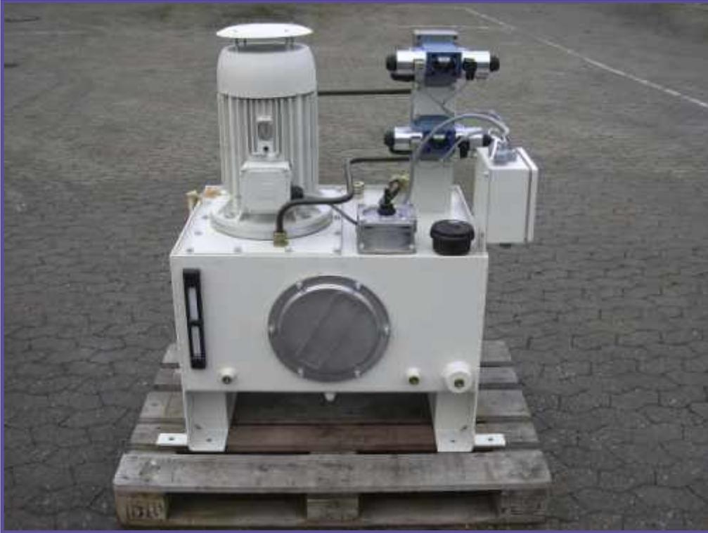
Hydraulikaggregat als Zentralhydraulik für mehrere Verbraucher.
