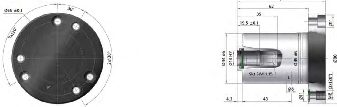
ROTODISK S2-S, Typ 10573 – 10.000 min -1 / Emulsion, 70 bar / Luft, 10 bar
