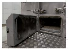
In Verbindung mit einer automatischen Sargeinfuhrmaschine entfallen aufwendige Arbeiten im laufenden Betrieb, wie zum Beispiel das händische Abreinigen der Muffel.
