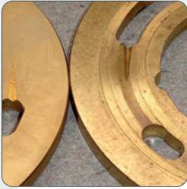
Riefen durch Abrieb (Pumpe)
