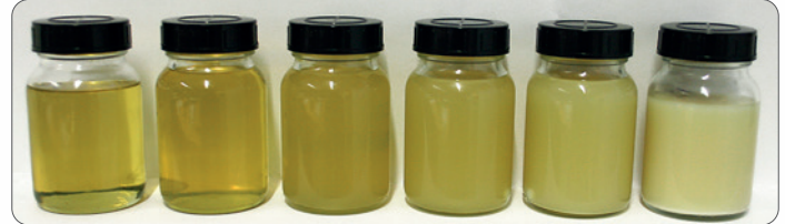
Hydraulikölproben mit unterschiedlichem Wassergehalt.
