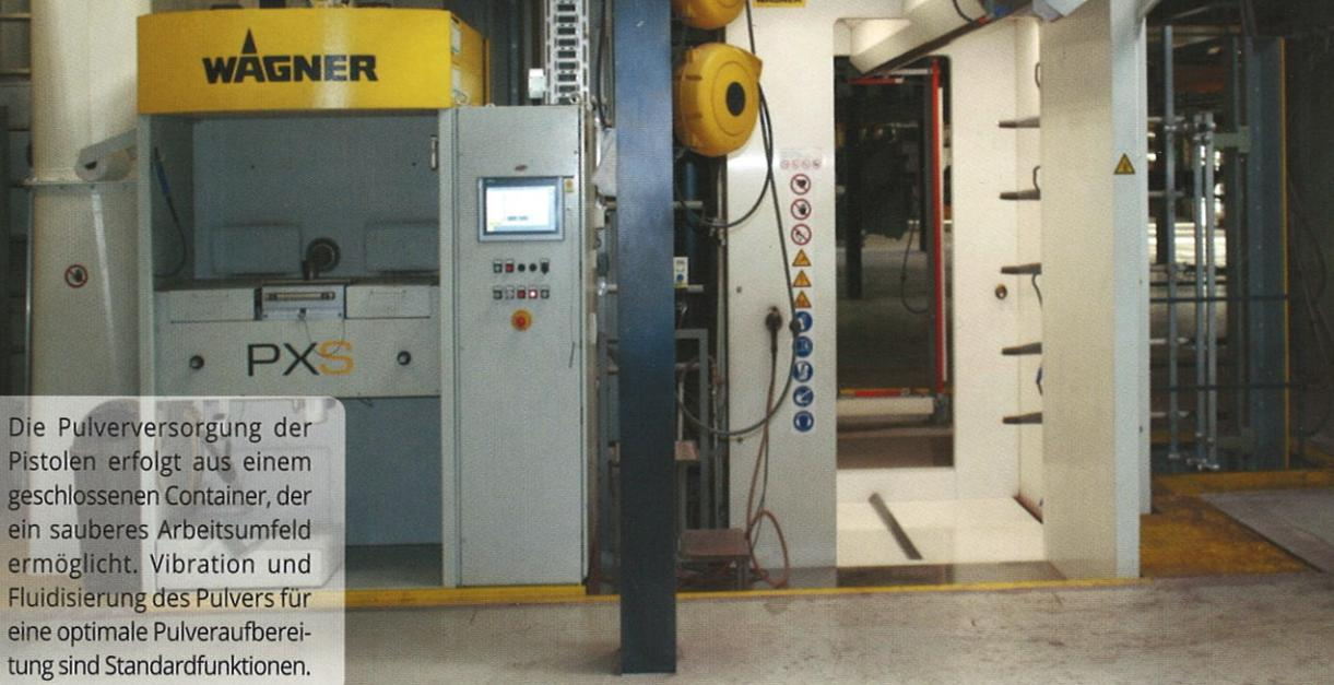
Die Pulverversorgung der Pistolen erfolgt aus einem geschlossenen Container, der ein sauberes Arbeitsumfeld ermöglicht. Vibration und Fluidisierung des Pulvers für eine optimale Pulverauffbereitung sind Standardfunktionen.
