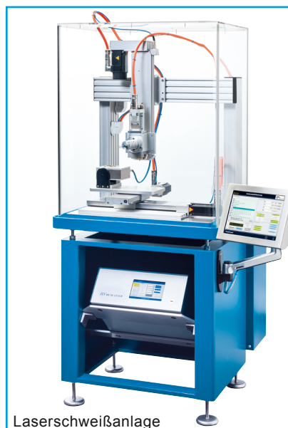
Handlingportal aus ERO-Speed Komponenten
