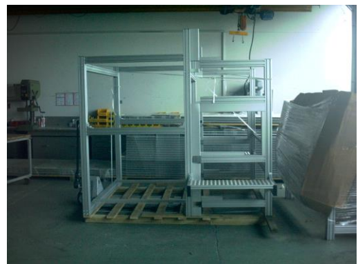
Bedienergestell mit Kabelkanälen für Extrusionsanlage
