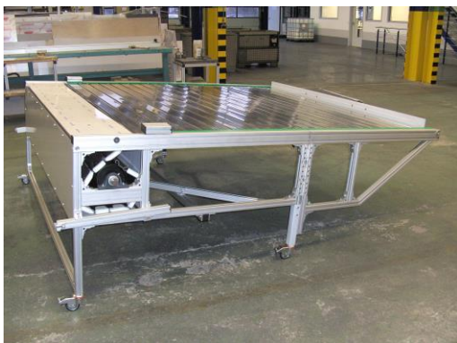
Tisch mit Rollladenfläche ausziehbar, für PC-Platten
