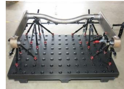
Tetrafix modulare Messaufnahme mit „Tripods“ auf der Grundplatte
