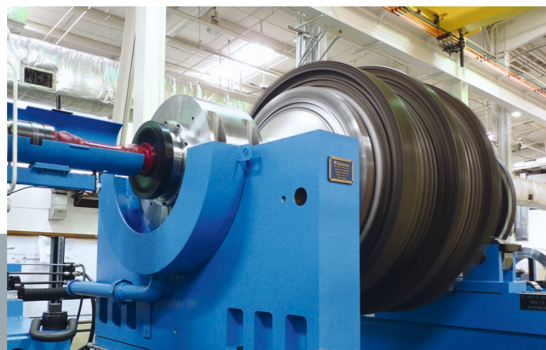
Auswuchtmaschine mit Gleitlagerung für bis zu 100 t schwere Gasturbinenläufer
