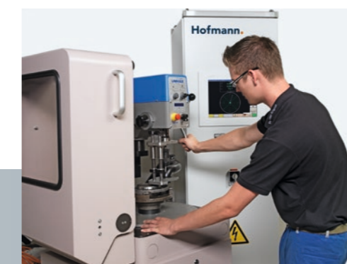
Auswuchten eines Kundenrotors bei Hofmann
