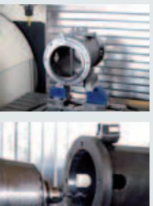
Fertigung von Einzelteilen und Serien. 5-Seitenbearbeitung von Metall und Kunststoff in einer Aufspannung.
