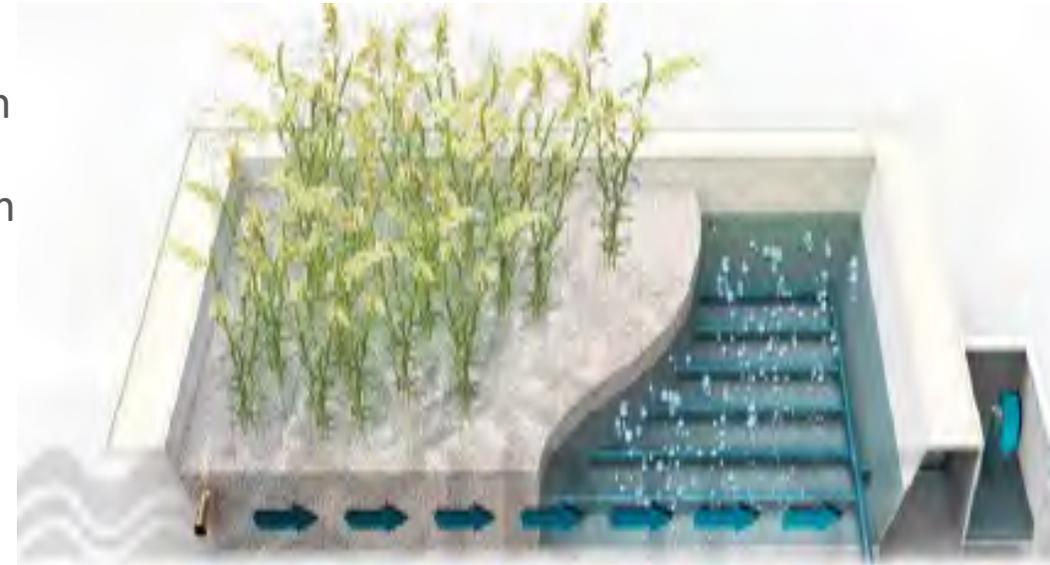
Schema eines gleichmäßig belüfteten Pflanzenbiotops – als vierte Reinigungsstufe. Die Rhizome werden belüftet – teils können Spezialpflanzen verwendet werden, um bestimmte Stoffe zu binden (z.B. Metalle)
