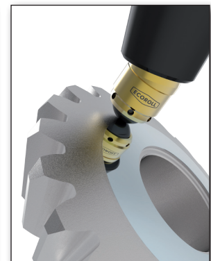
Glattwalzen der Kugelzone eines Kegelrades.
