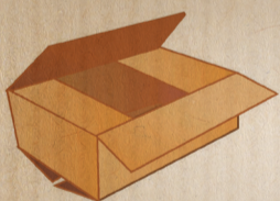
Fefco 0201: Standard Faltkarton ▪ mit stoßenden Boden- und Deckelklappen
