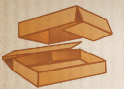
Fefco 0331: Gekremelte Stülp garnitur ▪ Seitlicher Schutz durch 3-4 fache Pappstärke ▪ auch für unterschiedliche Füllhöhen
