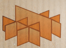
Fefco 0935: Gefache ▪ Steckgefache oder ▪ Schiebegefache
