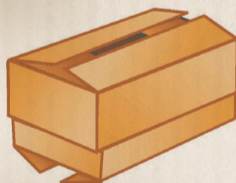
Fefco 0320: Stülp garnitur/ Teleskopverpackung ▪ für unterschiedliche Füllhöhe
