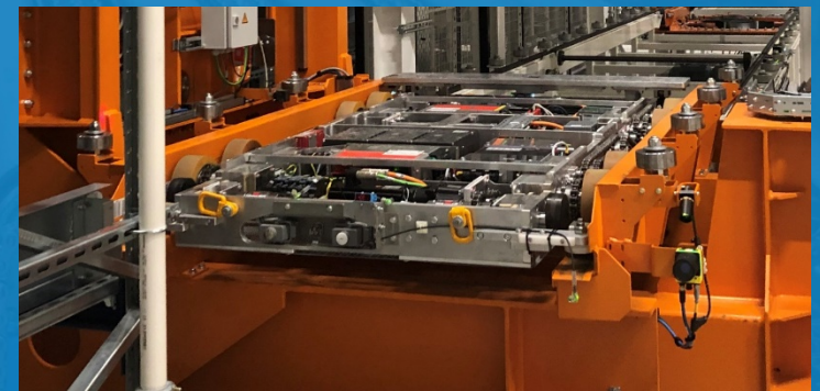
Satellit im Betrieb (ohne Abdeckung)
