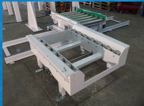
Stapleraufgabe und verteilerwagen
