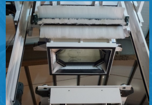
Jacketheber und Palettenkippstation
