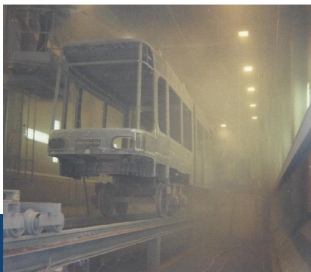
Waggonstrahlanlage in Betrieb
