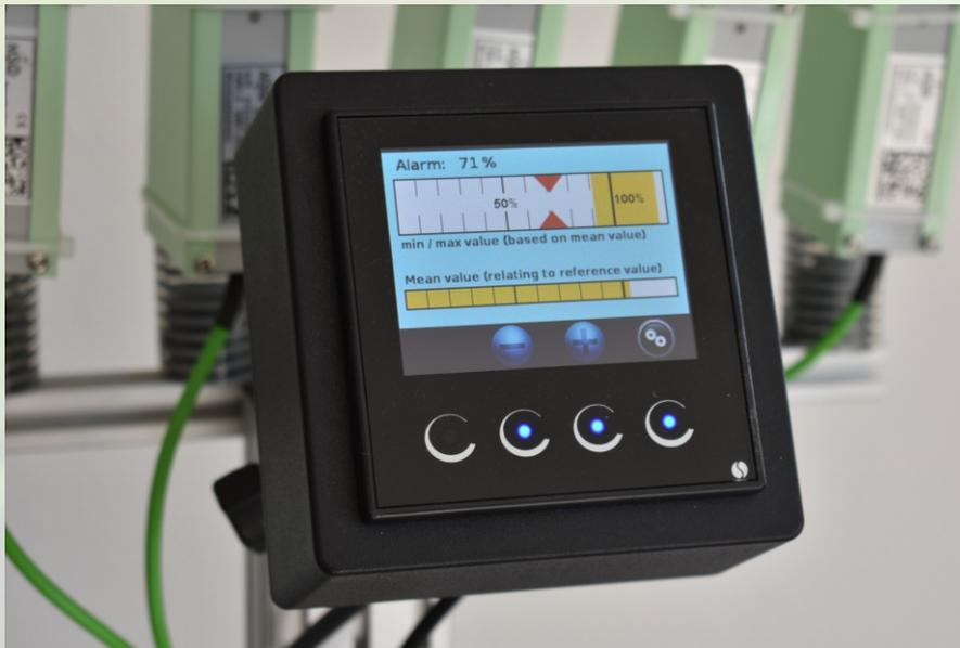
Der **SeedMon** ist die Lösung zur Durchsatz- und Funktionsüberwachung von Sämaschinen und Dünger- bzw. Gülleverteiltern zur Nachrüstung und für Erstausrüster (OEMs). Teilblockaden mit verringertem Durchsatz werden sicher und sofort erkannt. Die **SeedMon** Düngerüberwachung - mineralisch und organisch (Gülle) - stellt die zuverlässige Dosierung insbesondere bei Unterfuß Anwendung sicher.
