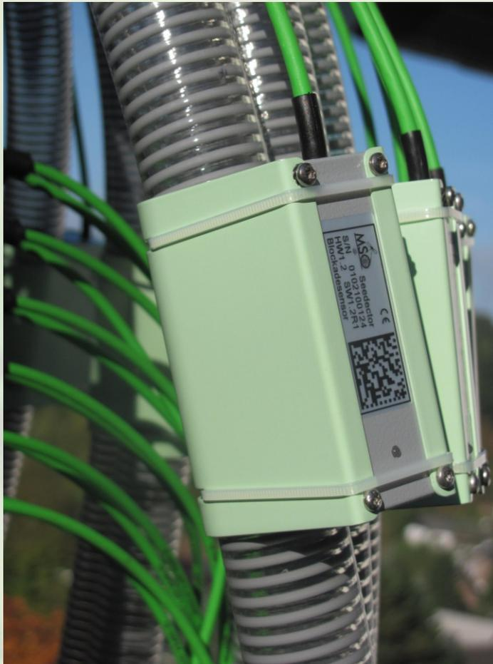
Der **SeeDector** bietet ein neues Verfahren zur Erfassung der Menge und Geschwindigkeit von Gutströmen aus Partikeln (z.B. Saatgut, Dünger, Granulat) oder Flüssigkeiten (z.B. Gülle) in Bewegung in Leitungen.
