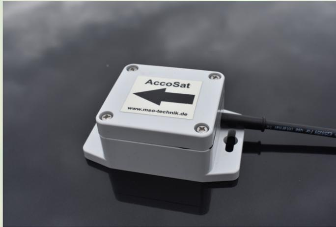
Der **MSO AccoSat** misst die wahre Geschwindigkeit von Fahrzeugen und deren Anbaugeräten in Echtzeit mit dem DGPS-Empfänger, der mit dem Beschleunigungssensor kombiniert ist. Durch diese Sensorfusion reagiert das System sehr schnell auf Beschleunigung (Anfahren und Abbremsen). Die Messung ist unbeeinflusst von effektivem Radumfang, Einsinkung und Radschlupf.
