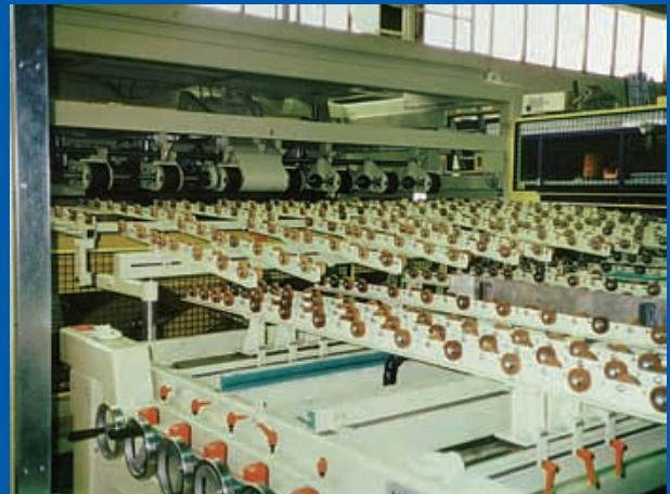
Platinenentstapelanlage mit Zentrierstation
