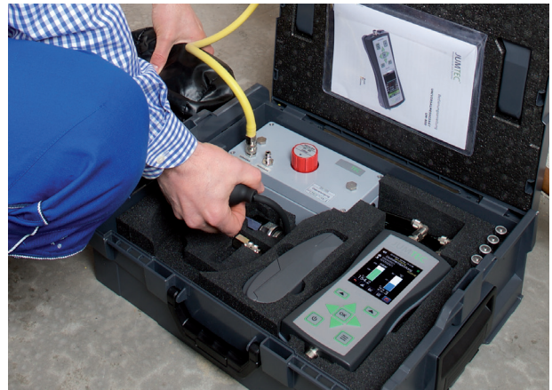
Leckmengenmessung mit Zähler mit externer Gasversorgung GV-100
