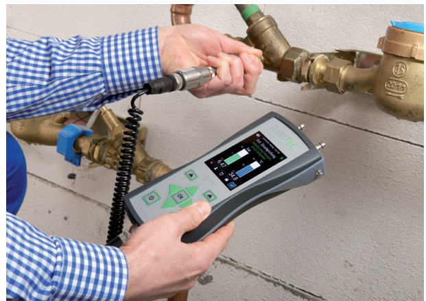
Einsatz mit Hochdrucksensor bis 25bar
