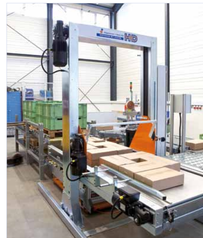
Ergonomisch Palettieren mit vollautomatischem Lagenpalettierer.
