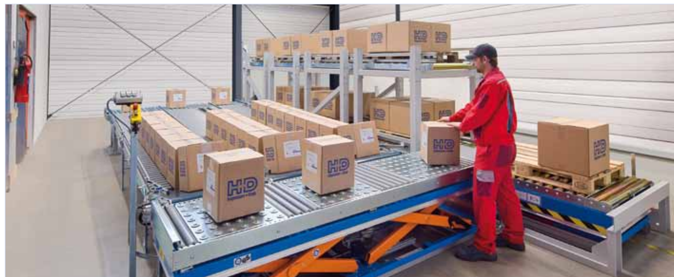
Höhenverstellbarer Wareneingangskontrollplatz für Kartons und Paletten.
