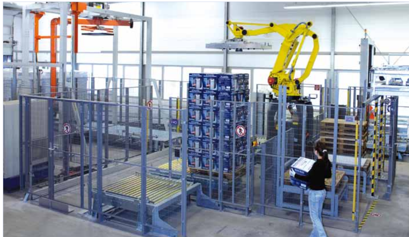
Vollautomatischer Palettierroboter mit Dreharm-Stretchanlage für effizientes Palettenhandling.
