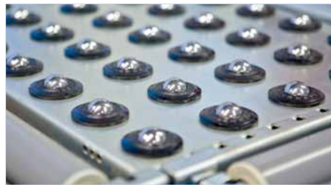
Kugeltische erleichtern das Handling von Kartons und Behältern.
