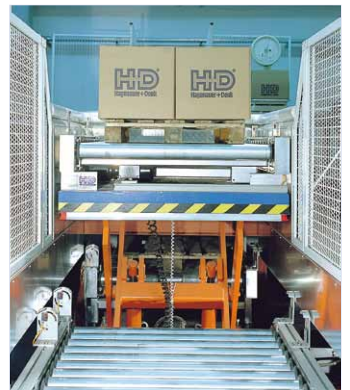
Hand-Palettierplatz auf Podest mit Scherenhubtisch und Palettenrollbahn.
