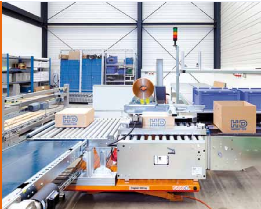
Altersgerechter Arbeitsplatz mit vollautomatischer Höhenanpassung.
