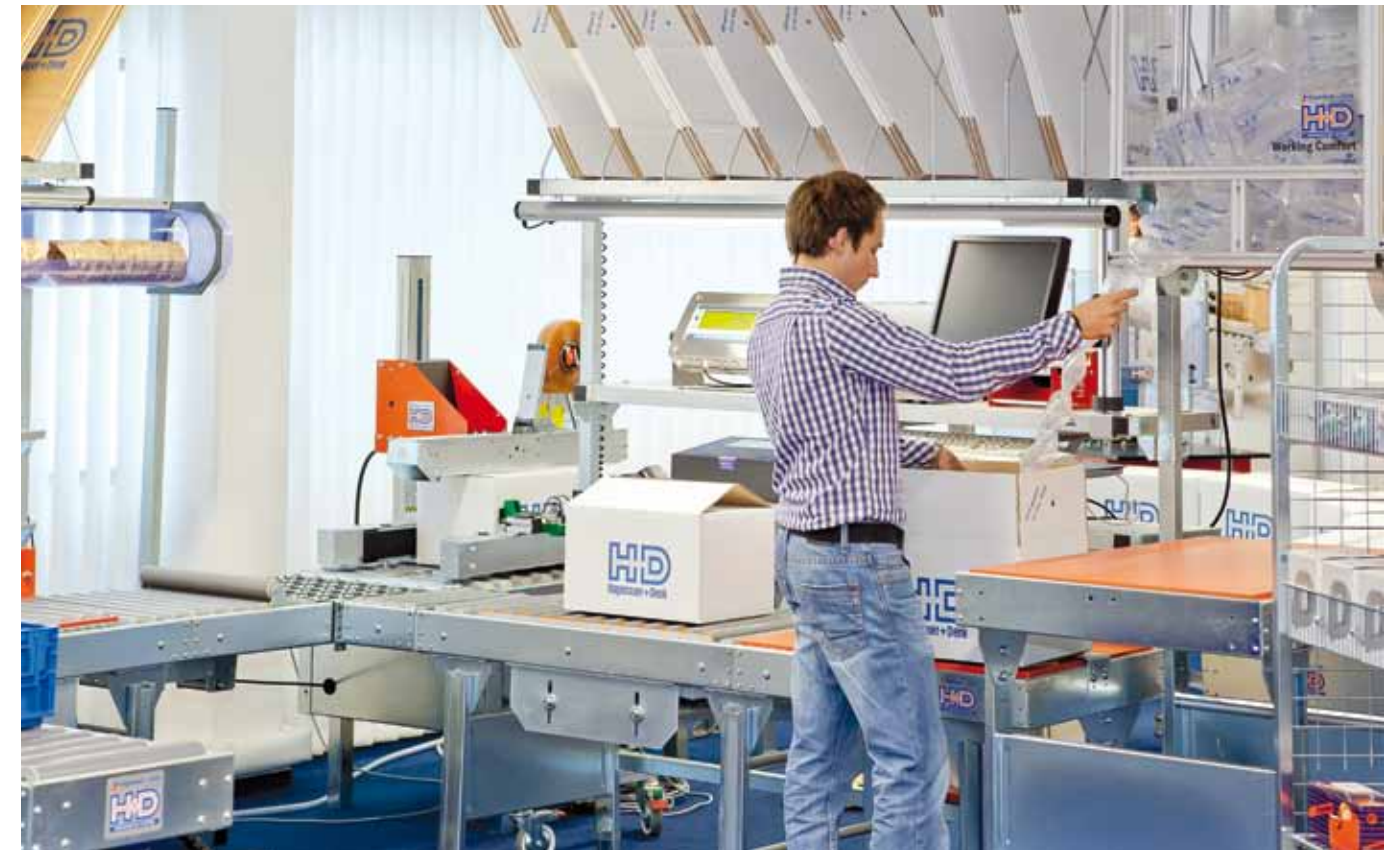
Kennzeichen ergonomischer Packplätze: richtige Bauhöhe und greifraumgerechte Anordnung der Materialien.
