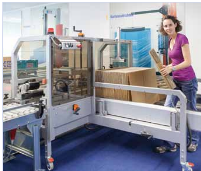
Vollautomatischer Kartonaufrichter mit integriertem Bodenschließer stellt Kartons im Sekundentakt bereit.
