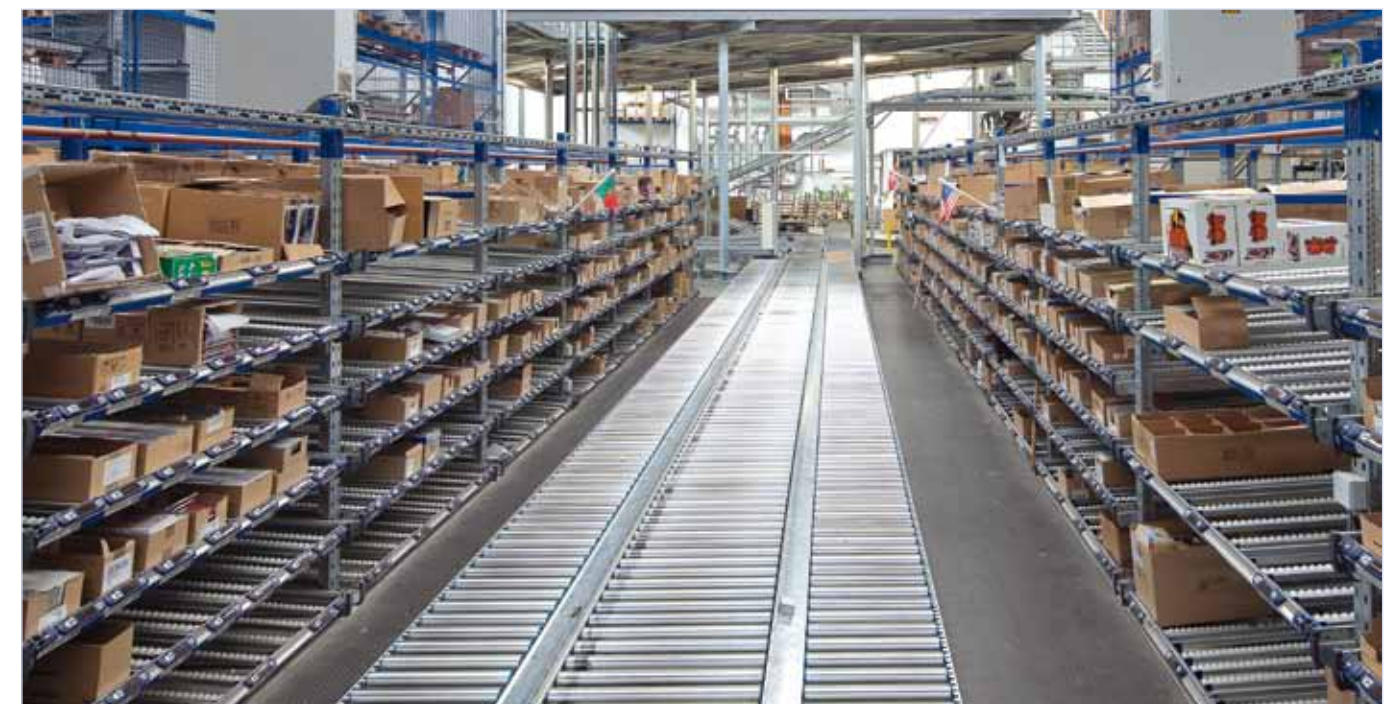
Pick & Pack: flexible Mehrplatzanlage mit Pick-to-Light-Kommissionierung.
