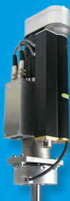
Prüfschrauber zur Radialspielmessung: DSM fertigte den Spezialschrauber und programmierte die Steuerungssoftware.
