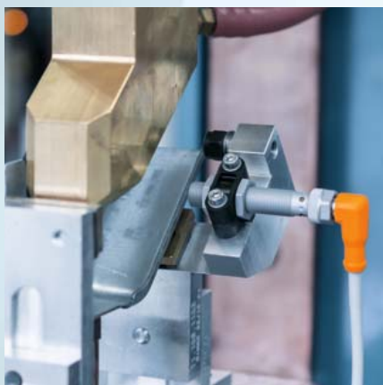
Die Baureihe ecolink EVW ist optimiert für den Einsatz im Schweißbereich. Die Antihafbeschichtung von PUR-Kabel und Überwurfmutter lässt Schweißspritzer abperlen.
