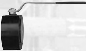
Kompaktkugelhahn BV 8/A+R aus Stahl PN 16 Kugel: Edelstahl / Dichtungen: PTFE bis DIN 50 auch PN 40
