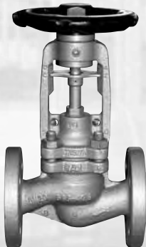
ARI-Faltenbalgventil Supra C Edelstahl, doppelwandiger Faltenbalg verschweißt, Kantensitzkegel einteilige Spindel (TA-Luft-Zulassung)
