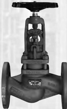
ARI-Faltenbalgventil Supra I Stahlguß, doppelwandiger Faltenbalg verschweißt, Kantensitzkegel zweiteilige Spindel (TA-Luft-Zulassung)
