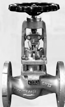
ARI-Faltenbalgventil Supra C Edelstahl, doppelwandiger Faltenbalg verschweißt, Kantensitzkegel zweiteilige Spindel (TA-Luft-Zulassung)
