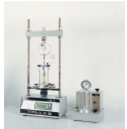
Typische Konfiguration eines Standard Test-Sets für die Bestimmung der undrainierten Scherfestigkeit (UU) an einer Probe Ø 38 mm. Öl- und Wasser-Drucksystem.
