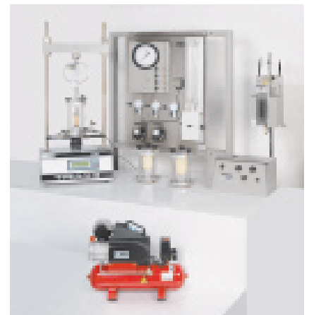
Typische Konfiguration eines Test-Sets für die Bestimmung der konsolidierten-, undrainierten Scherfestigkeit (UU) mit Messung des Porendrucks und der Volumenänderung. Medientrenner-Luft/Wasser-Drucksystem und Wasserentlüftungseinheit
