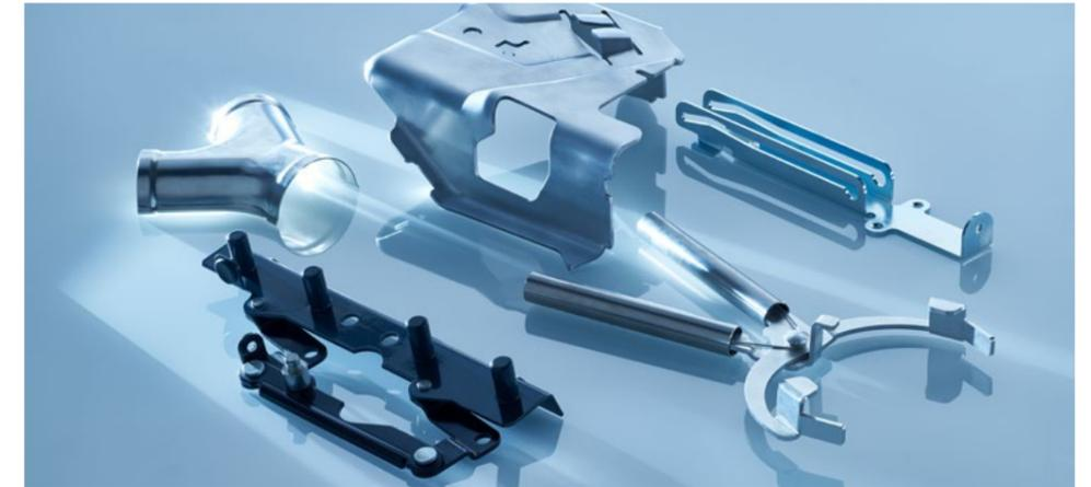
In der Fertigung verfügen wir über Stanzmaschinen mit einer Umformkraft bis 2000 KN. Hier produzieren wir nach erfolgter Freigabe der Erstmuster mit präzise gefertigten Werkzeugen Stanz-, Biege-, Zieh- und Prägeteile in allgängigen Materialien. Diese Teile können anschließend einer Oberflächenveredelung zugeführt und weiter zu Baugruppen montiert werden. Laufende prozessbegleitende Qualitätssicherungsmaßnahmen und dokumentierte Prüfungen gehören zum täglichen Produktionsablauf.
