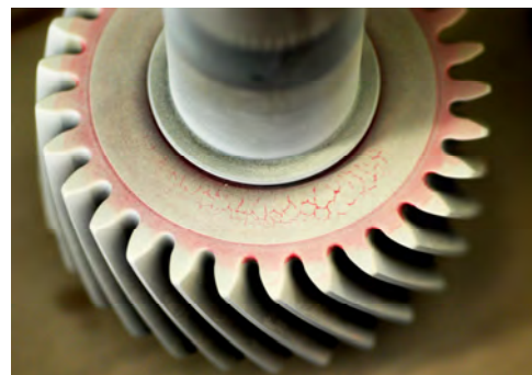
Fehleranzeige sichtbar gemacht mit Farb-Eindringssystem
