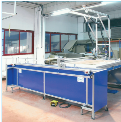
Bickers-JMP GLUEJET® Klebetisch mit integriertem Hubtisch: Option PA2
