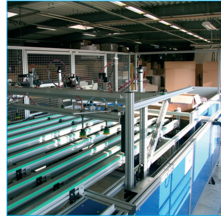
Bickers-JMP GLUEJET® Klebetisch mit automatischer Produktzuführung: Option CI
