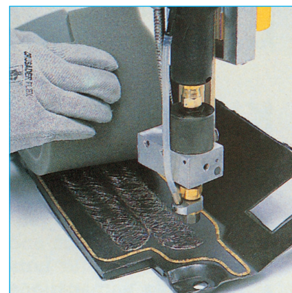
Elektrischer Auftragskopf E100XT ausgerüstet für Spinnsprühauftrag
