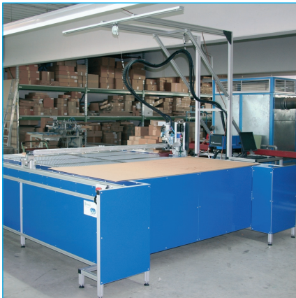
Bickers-JMP GLUEJET® Standard-Klebetisch mit 4 unabhängigen Arbeitsplätzen
