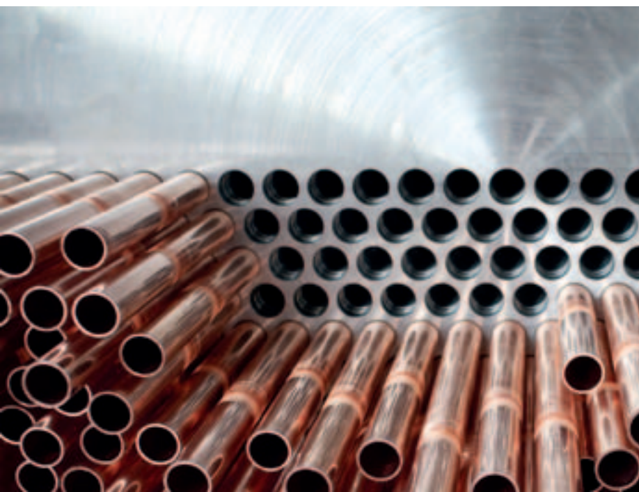
Verdampfer mit aufgebautem Kondensator für eine kombinierte Fernwärme-/Fernkälteanlage
