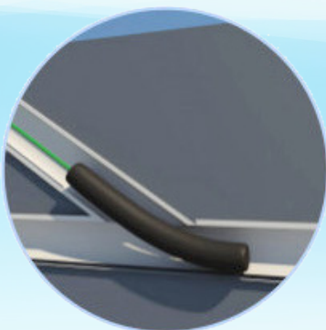
Die Blase in die Mitte des Anschlusses einsetzen.
