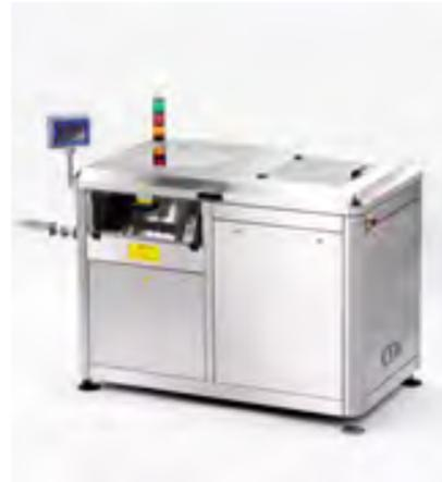
Automatische Gefäßaufrichter mit Trichter (von hoher Kapazität)
