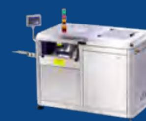
AUTOMATISCHER AUFRICHTER FÜR GEFÄSSE MIT TRICHTER (VON HOHER KAPAZITÄT)
