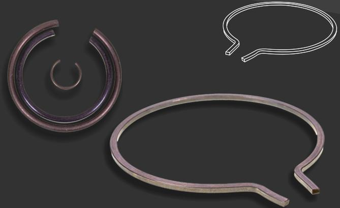
Sicherungsringe werden neben Schrauben, Muttern, Scheiben, Nieten, Wälzlagern und anderen Massen- und Normteilen am Häufigsten angewendet. Sie zeichnen sich aus gegenüber anderen Maschinenelementen zur axialen Fixierung von Bauteilen auf Wellen und in Bohrungen durch den günstigen Preis, die einfache Montage und die einfache und preisgünstige Fertigung der Nuten zur Aufnahme der Ringe.
