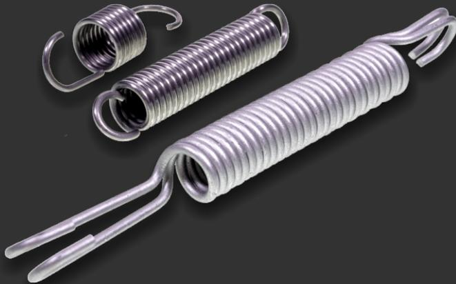
Zylindrische Schraubenzugfedern werden mit enganliegenden Windungen gefertigt. An beiden Federenden befinden sich Ösen, welche angebogen oder eingeschraubt werden. Es gibt viele Faktoren, welche die Feder- und Ösenform beeinflussen können.
