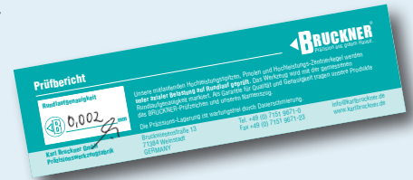
Prüftabelle „Rundlaufgenauigkeit“ am Beispiel Typ S, SG
