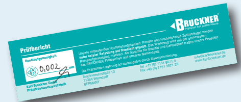
Prüftabelle „Rundlaufgenauigkeit“ am Beispiel Typ ZA, ZAG
