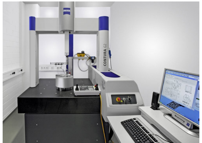
Zeiss Contura G2 Koordinatenmessmaschine mit 5 Achsen
