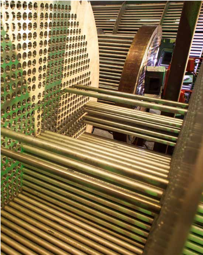
Berohren eines Wärmetauschers / Tubing of a heat exchanger
