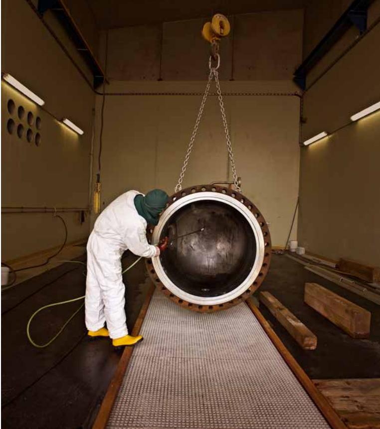
Beizanlage / Pickling Line
