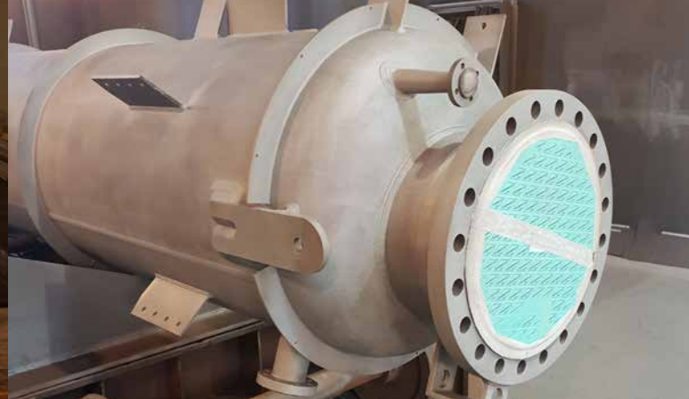
Oben: Strahlanlage / Top: Blasting plant; Unten: Apparat nach dem Strahlen / Bottom: Apparatus after blasting
