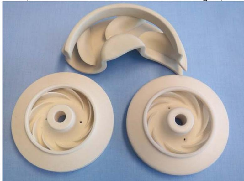
*offene und geschlossene Laufräder mit Hinterschneidungen
