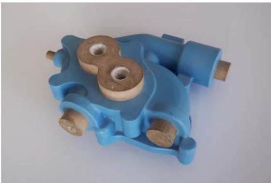
*Pumpengehäuse mit Kernen*
