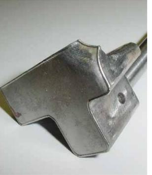
An der Auswerferseite eines Spritzgusswerkzeugs wurde der Kantenausbruch geschweißt
