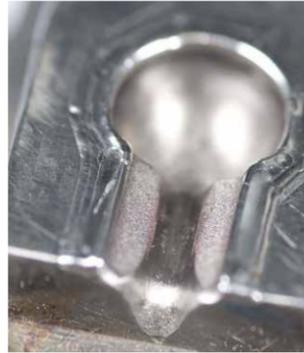
Bei Turbinenschaufeln wurde der beschädigte Konturbereich ausgebessert
