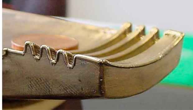
Reparatur der verschlissenen Dichtkante eines Formeinsatzes aus Ampco-Bronze
