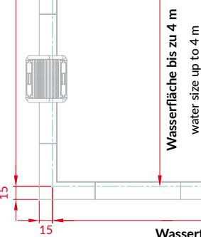
Integrierter technischer Raum für Dolcevita Diva mit Breite der Wasserfläche von 2,5 - 3 - 4 m.
