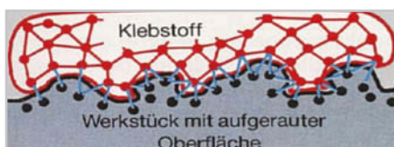
Durch Aufrauen der Werkstoffoberfläche wird die Kontaktfläche für den Klebstoff vergrößert.
