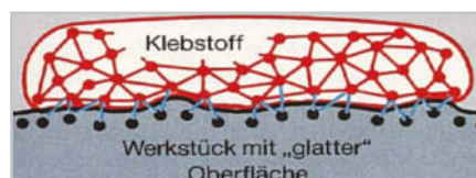
Je flüssiger der Klebstoff, umso leichter ist die Benetzung der Werkstückoberfläche.
