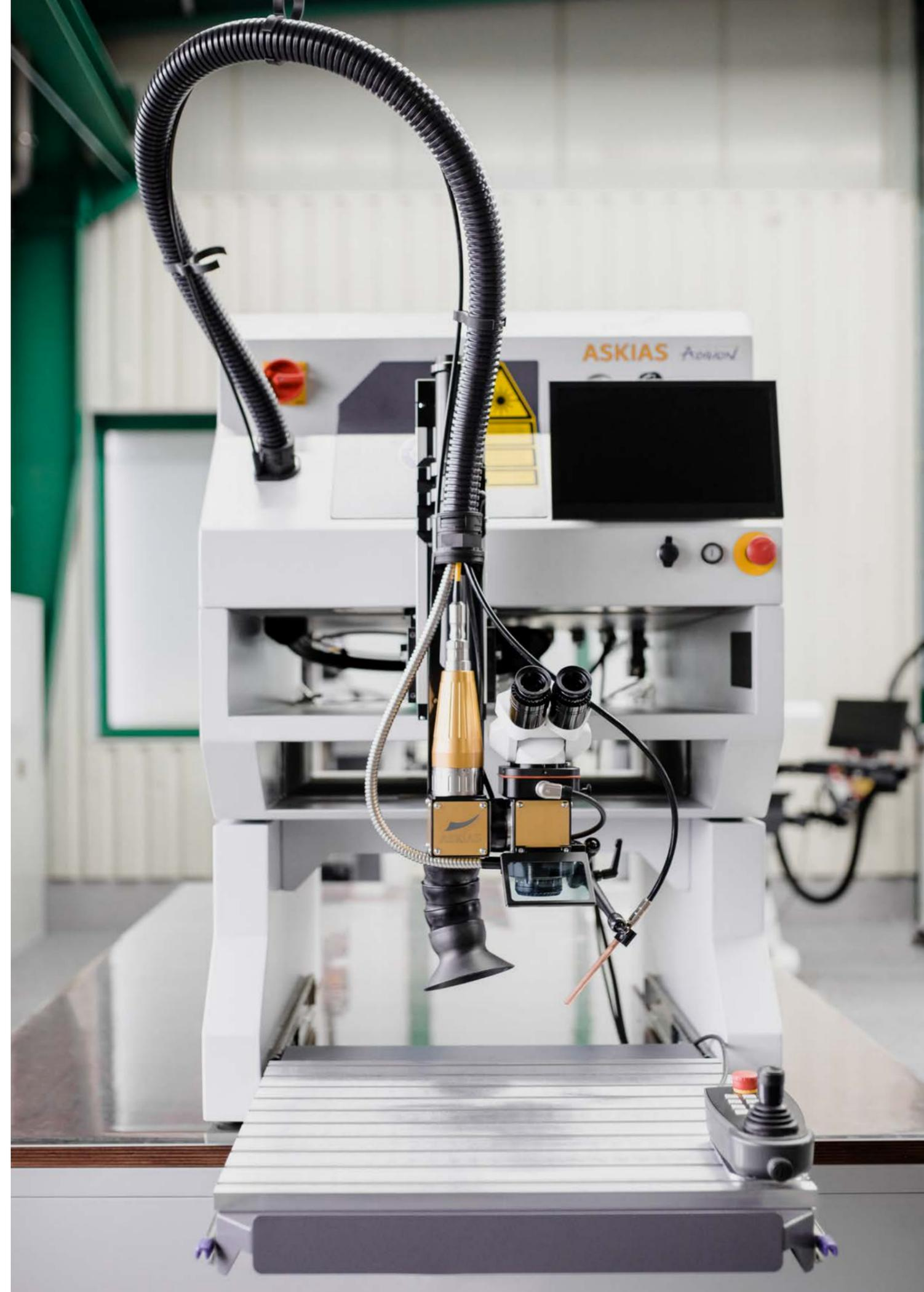
Das präzise Bearbeitungszentrum für alle Anwendungen. Egal ob Bohren, Schneiden, Schweißen, Löten, Abtragen oder Strukturieren und Beschriften von Metallen, Keramik und weiteren Materialien – die ASKIAS Precision vereint alle Funktionen in einer Maschine. Abhängig von Ihren Anforderungen beraten wir Sie individuell bei der Auswahl der passenden Laserquellen und Bearbeitungsköpfe.
