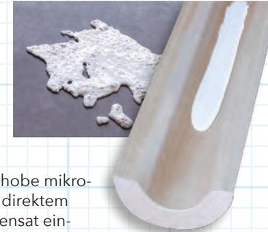
MBH1000 ist eine hydrophobe mikroporöse Platte. Sie kann in direktem Kontakt mit Wasser/Kondensat eingesetzt werden. Sie ist bis 1000 °C beständig und isoliert ebenfalls mit 0,034 W/m\*K@800 °C besonders gut.
